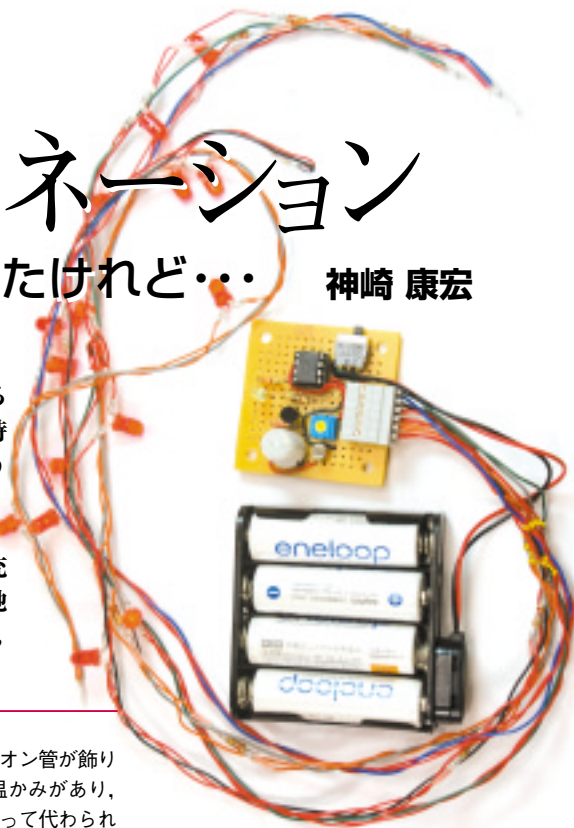
ユニバーサル基板に組んだ回路とLEDケーブル
