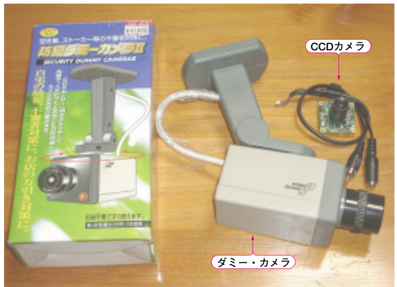
写真1 秋葉原のショップで購入した「防犯ダミーカメラⅡ」と、秋月電子通商の26万画素CCDカメラ・ユニット(32mm角、レンズ含む高さ32mm)ダミーカメラⅡは電池で回転駆動する。この機構を取り除いてカメラ・ユニットを内蔵させた。
