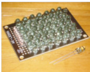
写真2 赤外線発光ダイ オード使用の赤外 線投光器のキット の例(秋月電子通商 で1,000円)
