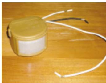
写真3 人体感知センサ・ キットの例 秋月電子通商の高感 度広角タイプ焦電型 赤外線センサ・ユ ニット「NS-300 GOLD」(1,200円)。 検出範囲は1.5～ 24mで、視野角は 110°。
