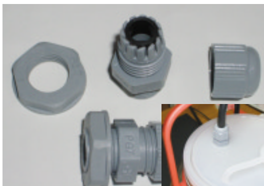
写真5 防水パーツのケーブル・グラウンド ケーブル類をケースなどに通すときの防水に使用する。内側にゴム・シートが付いており、キャップを締めつけていくとケーブル、ゴム・シート、本体が密着して浸水を防ぐ。
