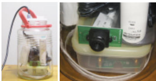
写真4 監視カメラを屋外に置くために果実酒用の4リットル・ビンにWebカメラ・ユニット(秋月電子通商の「Webカメラキット9060AK」, 8,200円)と無線LAN イーサネット変換メディア・コンバータ(パッファロー「WLI2-TX1-AG54」), AC100Vテーブル・タップを入れたもの。ケーブル・グラウンドはタカチ製PG7を使った。ビン底は、底上げ状で丸いためタップウェアの中にカメラの制御基板を入れた。無線LAN伝送により20mほど離れたパソコンで監視ができた。
