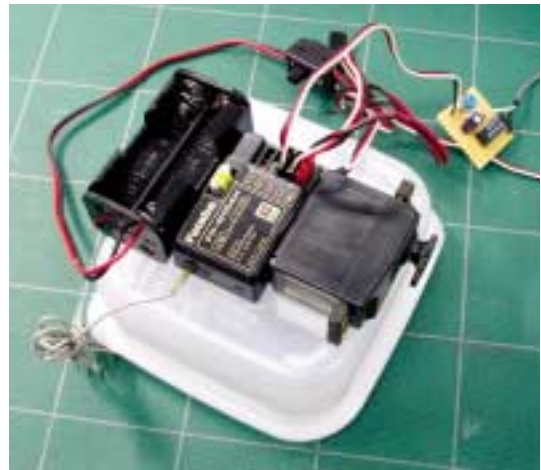
写真2-2 ラジコンをコントロールする受信機とサーボを接続したところ
