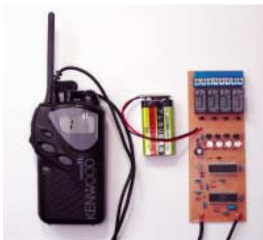
写真3-1 特小無線機と組み合わせて遠隔操作をする
