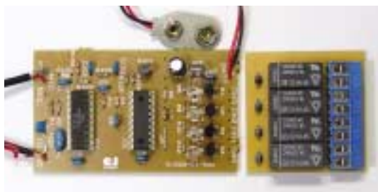
写真3-2 左がDTMF基板, 右がリレー基板
