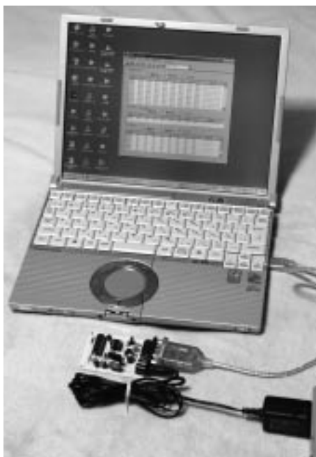
写真2-2 PICライタをノート・パソコンで使用しているようす
