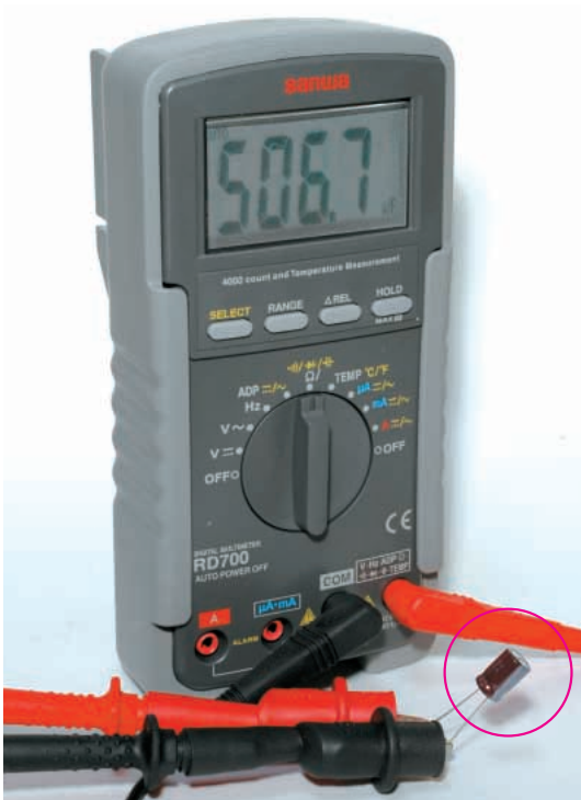
写真2-1 470μFの電解コンデンサの静電容量を測って見た
