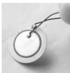
写真3 使用した圧電素子「ムラタ7BB-20-6L0」
