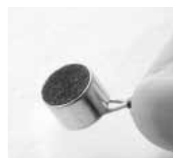
写真4 使用したコンデンサ・マイクロホン「アイコー電子CM-102R」
