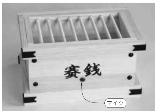
(b) 基板類を組み込んだ賽銭箱の模型
