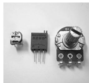
写真1-2 左から、半固定抵抗, 25回転型半固定抵抗, 可変抵抗
