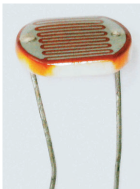
写真1 CdS素子の例 今回使用したのはφ5mmのものだが、これはφ8mmのもの。
