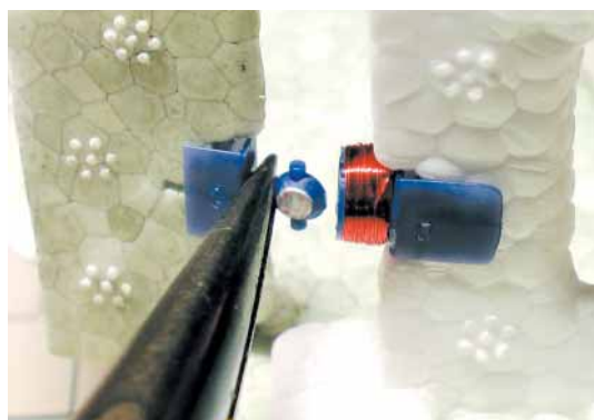
写真2-6 方向舵を外す
