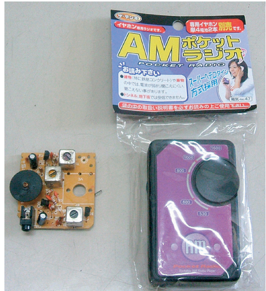
写真2 100円AMラジオの部品を流用する
