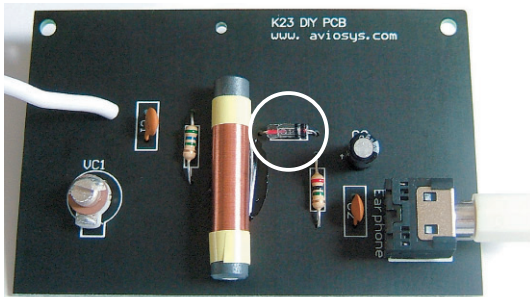
写真1 検波にゲルマニウム・ダイオード(○印)を使うラジオ。無電源で動作する
