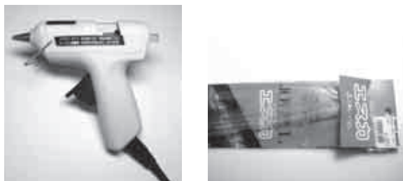
写真5 (a) グルーガン 光ファイバの加工と固定
