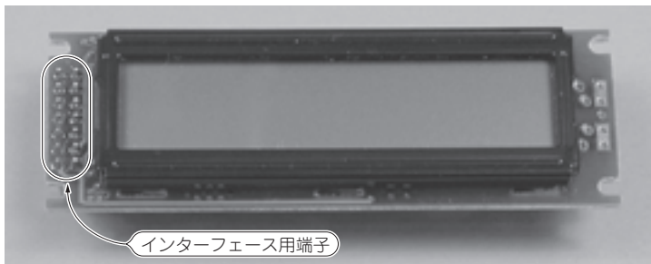
(a) キャラクタ・ディスプレイ・モジュール(16×2行)。秋月電子通商で購入できる。商品名は「LCDキャラクタディスプレイモジュール(16×2行バックライト無)」
