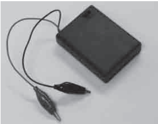
写真3 スイッチ付きの単3形もしくは単4形電池4本のボックスが便利
