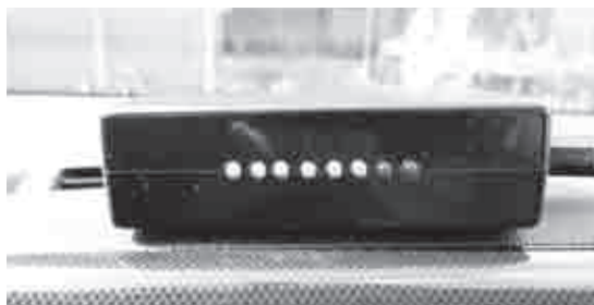
写真1 ecoドライブ・モニタ 加速度センサを用いて、急加速や急減速をLEDの光具合でドライバーや同乗者に知らせるマイコン電子おもちゃ
