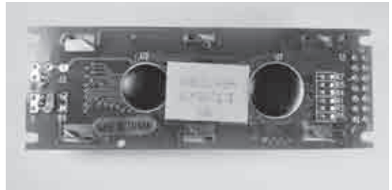
写真5-6 キャラクタ・ディスプレイ取り付けと部品配置のようす
