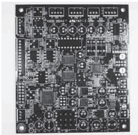
写真5-1 USB DAC機能のすべてが収められているメイン基板
