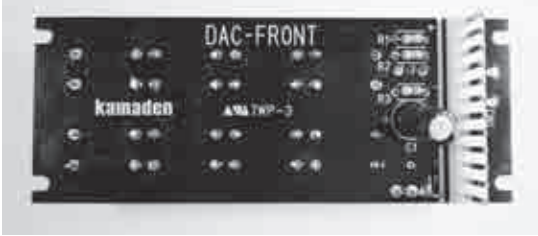
写真5-5 フロント・パネルはんだ面への部品取り付けのようす
