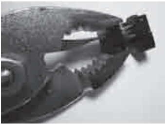
写真2-4 リボン・ケーブル処理のようす。プライヤなどで圧接する
